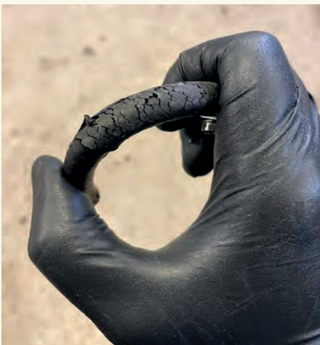
Tilstand på bensinslangar er eit viktig testpunkt på veteranbilar.
